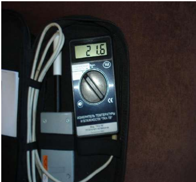
Фото 3. Фотофиксация показателя температуры воздуха в помещении установки шкафа.
